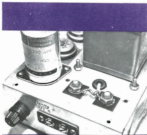
Lato d'uscita del telaio, su cui sono montati i diodi, la morsettiera d'uscita, il condensatore di filtro C3 ed il fusibile d'uscita F2.
