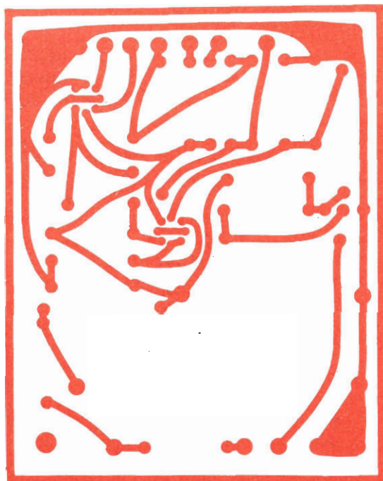
Fig. 5 - Circuito stampato in grandezza naturale; su esso si devono praticare i fori indicati nella fig. 2 e montare le parti illustrate nella fig. 3.
